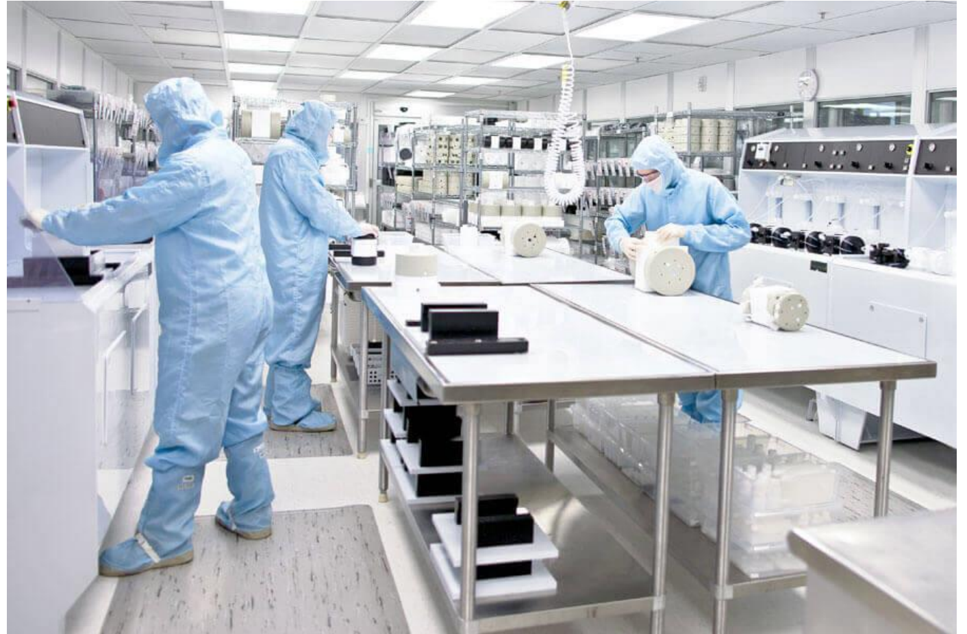
Čista soba za sklapanje pumpi
